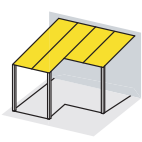
Pulldach mit Dachrinnenversatz
